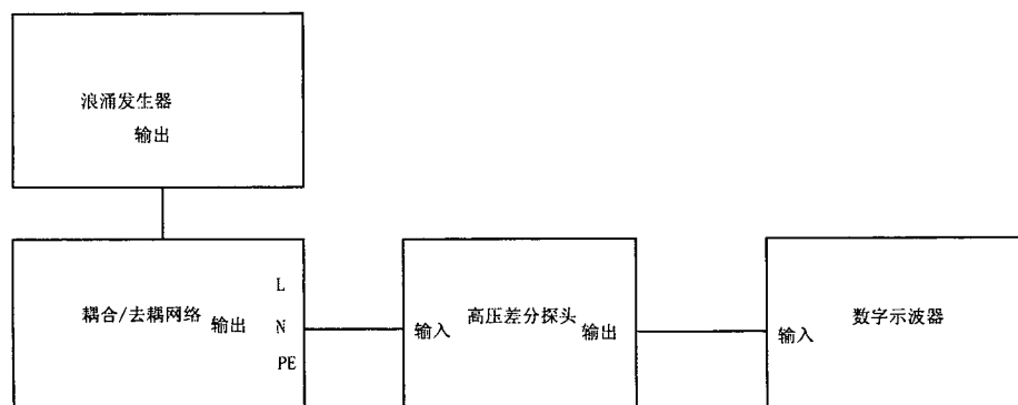
图 8 内置三相耦合/去耦网络开路输出电压峰值校准连接
