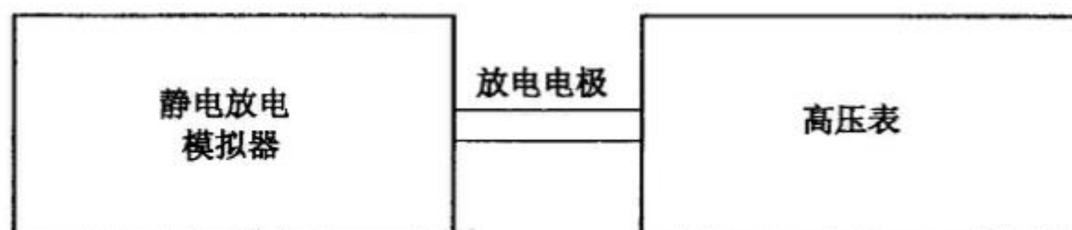
图 3 输出电压校准连接示意图
