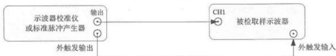
图 6 标准快沿法检定上升时间连接框图
