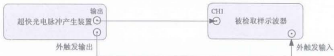
图8 超快光电脉冲检定上升时间的原理框图
