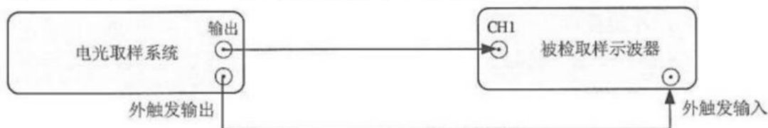
图10 电光取样脉冲法检定上升时间的原理框图
