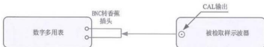
图 2 输出校准信号检定连接示意图
